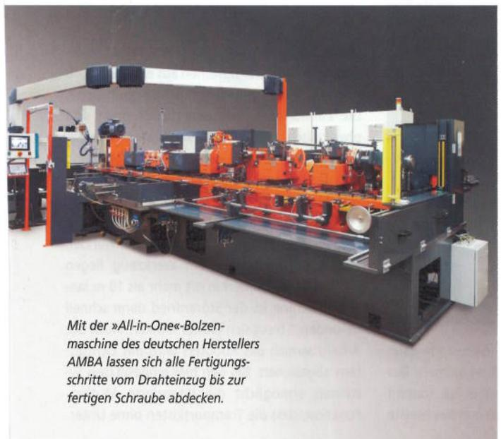
*Mit der »All-in-One«-Bolzenmaschine des deutschen Herstellers AMBA lassen sich alle Fertigungsschritte vom Drahteinzug bis zur fertigen Schraube abdecken.*
