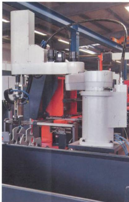
Klinken weiter. Dort werden die Produkte dann von einem SCARA-Roboter übernommen. Der hier eingesetzte, sehr kompakte Typ stammt ebenfalls von Omron, hat 1.200 mm Reichweite
