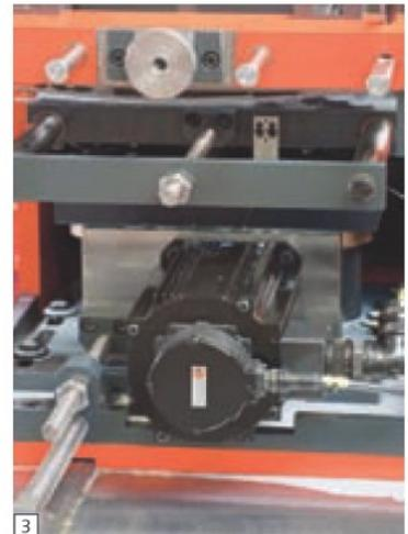
Bild 3: In Kombination mit dem Motion-Controller CJ1W-MC472 und dem Servoantrieb der G5-Serie ergeben sich ausserordentlich leistungsfähige Positioniersysteme, die nur wenig Einbauplatz benötigen. (Foto: Omron/AMBA)
