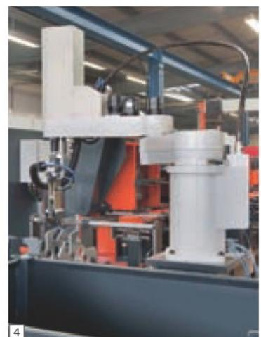
Bild 5: Die fertigen Teile können per Scara-Roboter geordnet in Transportboxen gelegt werden, um sie platzsparend und sicher zum Härten zu transportieren. Ein Lichtgitter mit integrierter Muting-Funktion sichert den Arbeitsbereich. (Foto: Omron)
