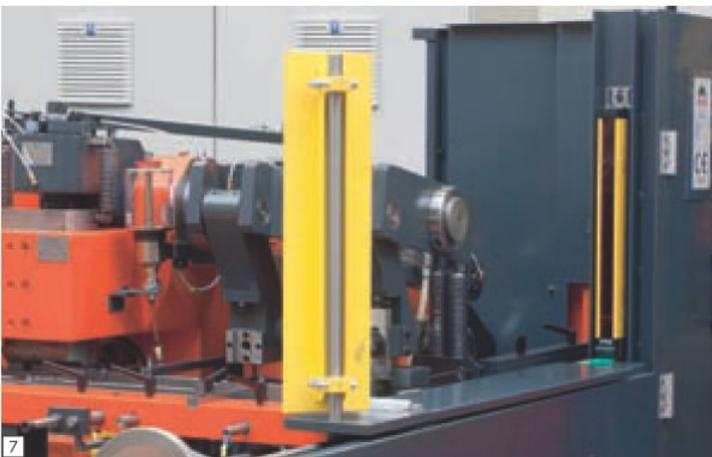
Bild 7: Lichtgitter der Baureihe MS4800 sichern den Zugang zur Bolzenmaschine. Es kann lokalisiert werden, an welcher Stelle der Lichtvorhang durchbrochen wurde. (Foto: Omron)
