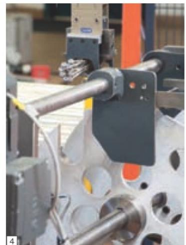
Bild 4: Hier werden die Schrauben gesammelt. Ein Umrichter übernimmt die notwendigen Positionieraufgaben. (Foto: Omron/AMBA)
