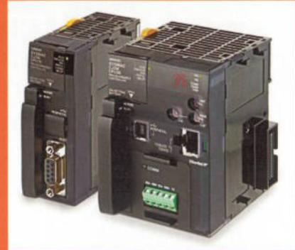
3: Herz der Maschine ist die Ablaufsteuerung CJ2M
