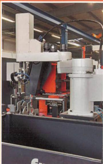
4: Die fertigen Teile werden per Scara-Roboter geordnet in Transportboxen gelegt. Ein Lichtgitter mit integrierter Muting-Funktion sichert den Arbeitsbereich.
